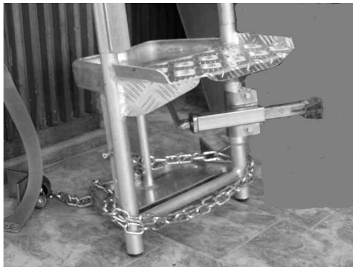
117. TE.M.A. munkaállással ellátott önhordó báziselem
