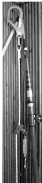
22.-23. Vezető kötélnél zuhanás gátlóval, kezelőrúddal
