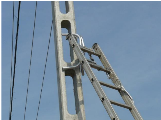
87. A létra felső részére szerelt támasztószervezet
